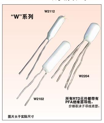
W系列: W系列元件是坚固耐用的圆柱形薄膜式陶瓷铂元件,它们可以在-50~600°C (-58~1112°F)温度范围内使用。这些元件配有直径0.38 mm (0.015")长度约为10 mm (0.4")的金-钯导线,它们可以减少陶瓷基片的应变。W系列元件有单元件和双元件配置,0°C电阻为100、200、400、500、1000和2000  $\Omega$ 。这些元件的电阻与温度特性符合IEC751,由于 0°C时的容差为±0.1%,因此其精度介于A级和B级要求之间。可以于在线技术参考部分找到电阻与温度表以及计算方程。
